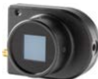
Beamage-4M-FOCUS (4,2 MPixels avec pixels effectifs de 10 \mu\text{m} Ouverture efficace de 20,5 x 20,5 mm)
